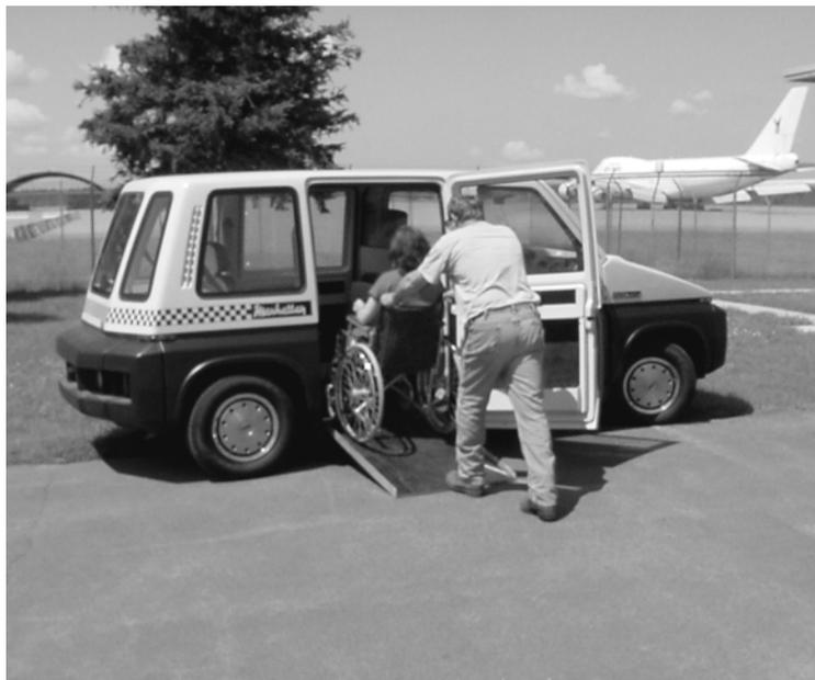
Un veicolo munito di rampa per l'accesso di una sedia a ruote
