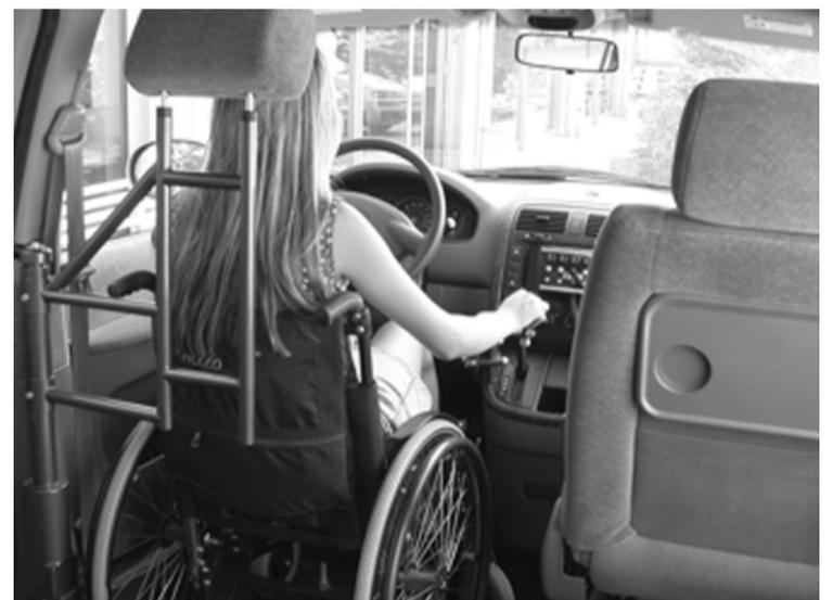
Una grande monovolume allestita con un sistema "sali e guida"
