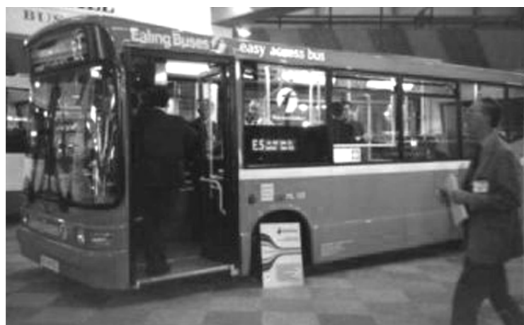
Un autobus per il trasporto urbano dotato di pedana elevatrice per passeggeri in carrozzina. Modello esposto in una fiera di settore in Inghilterra.
