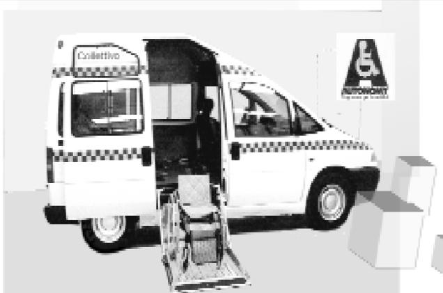
Veicolo con letto e porte rialzate. Sollevatore sottopianale laterale a completa scomparsa interna. Disponibile in varie versioni con altezza interna superiore a cm. 160 e altezza della porta laterale e/o posteriori superiori a cm.150
